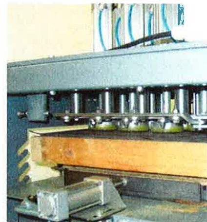
Figuur 4. De BDA Marathon Man Test voor het bepalen van de beloopbaarheid van dakisolatiematerialen.
