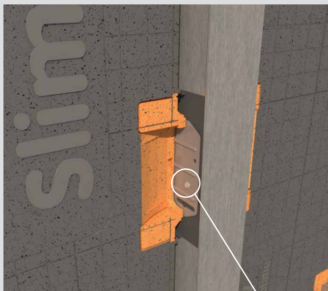
Profiel aan beide zijden vastzetten met één boorschroef.
