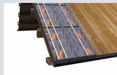
Mogelijkheid voor plaatsing extra tengels (25 x max. 40 mm), bijv. bij kopgevels, dakramen en dakkappen
